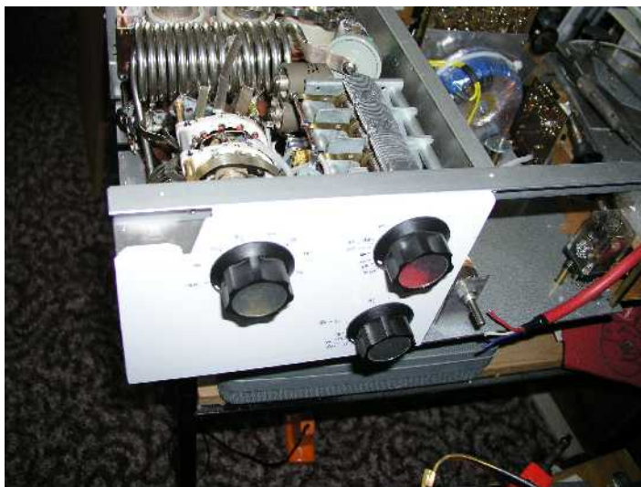
Obr. 26: Provizorní ocejchování C-Pí článku
