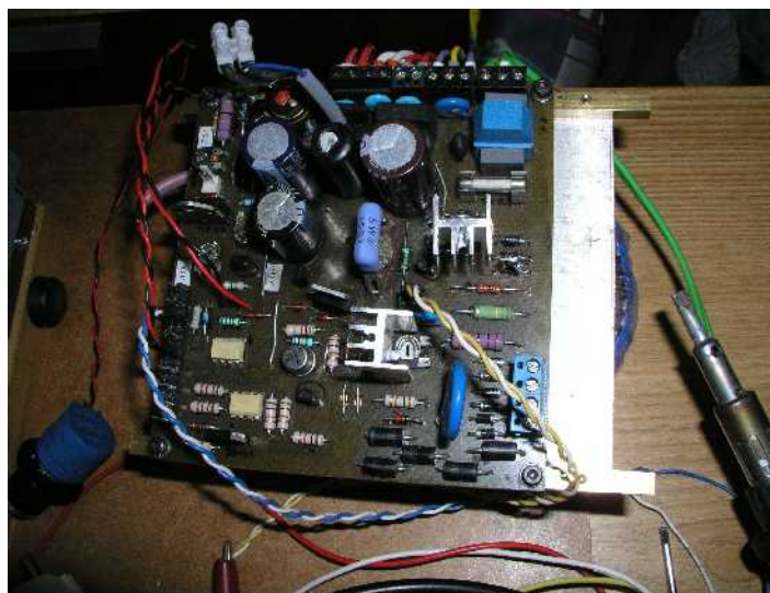
Obr. 12: Blok pomocného zdroje s ochranami
