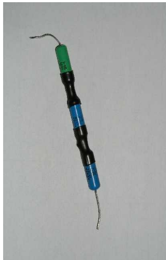
Obr. 25: Provedení anod. odporu 1700 Ohm z odporů TR-164
