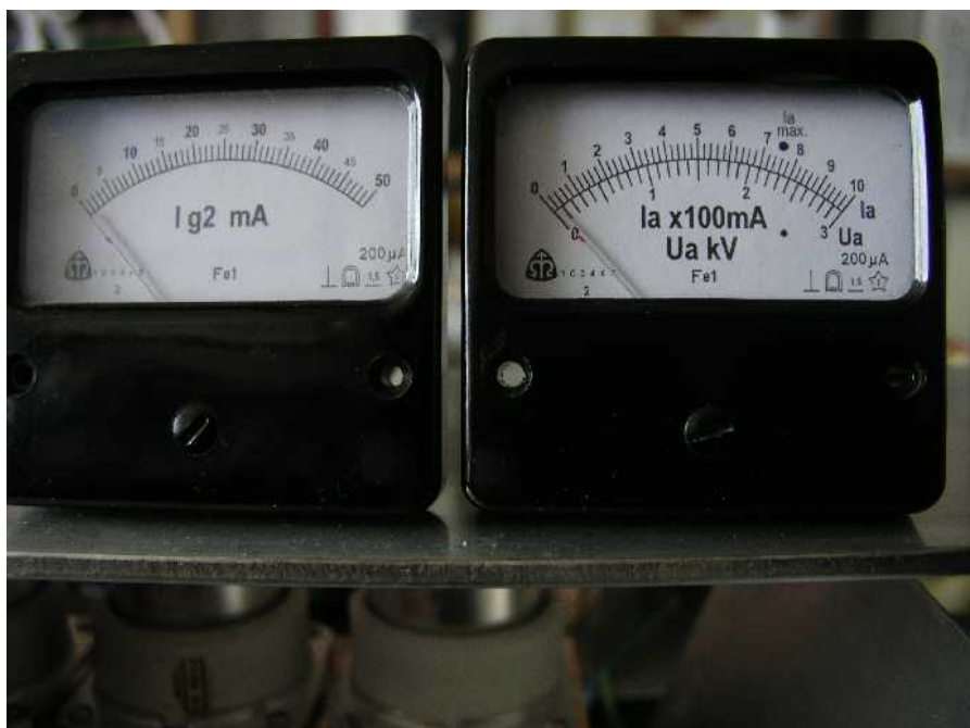
Obr. 13: přepracované stupnice měřidel
