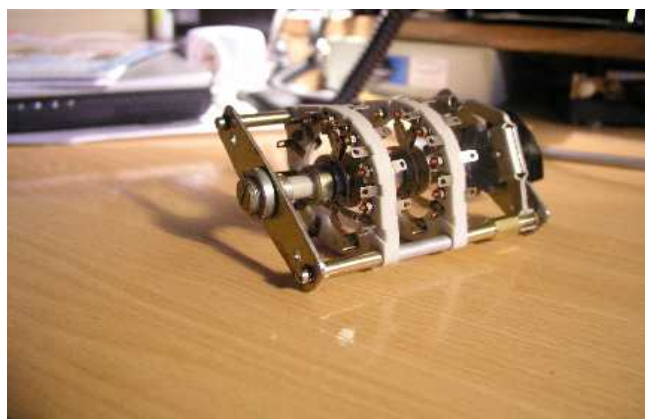
Obr. 11: Upravený přepínač t „Třínec“
