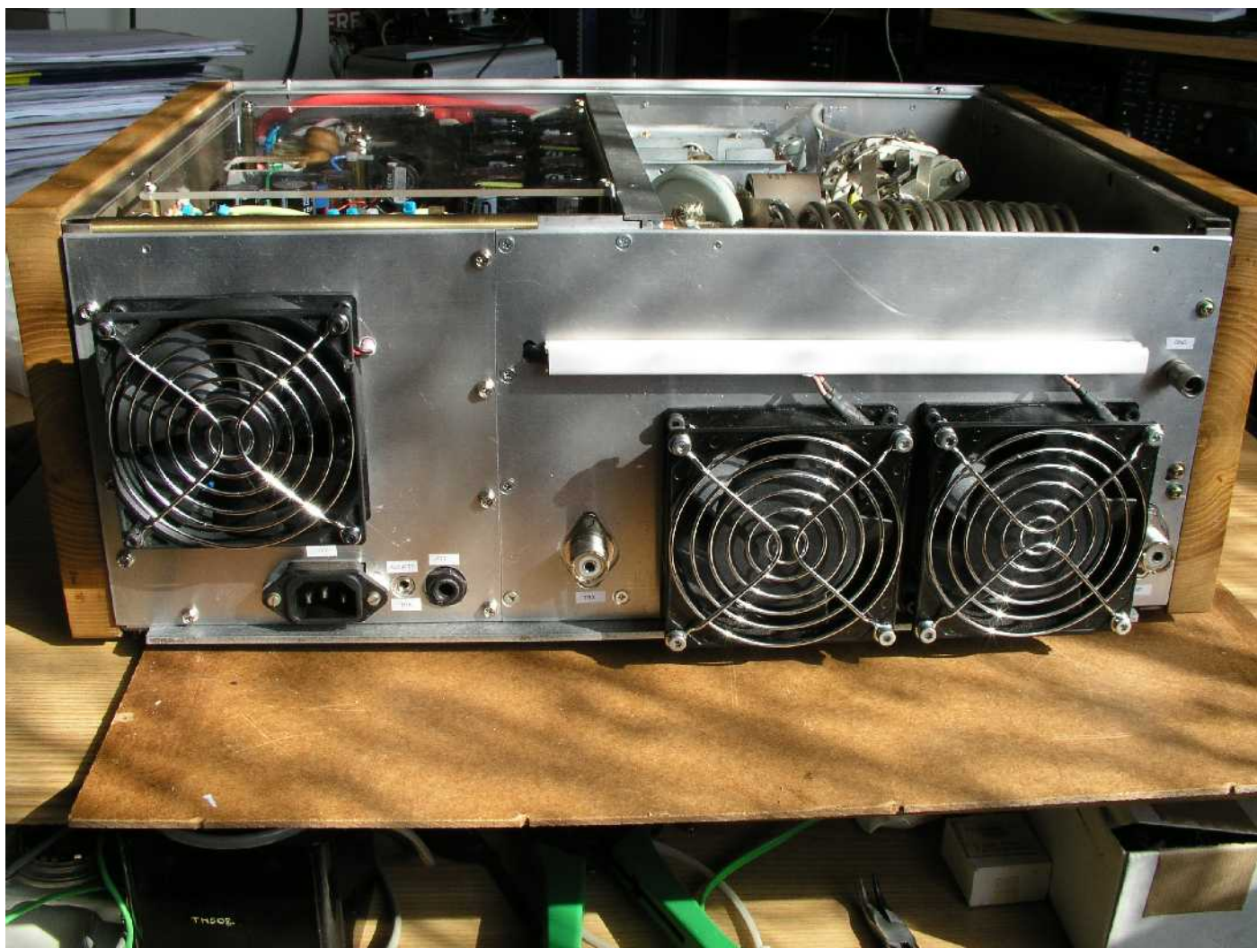
Obr. 52: Zadní strana PA s přidavným větrákem 12V za pomocným zdrojem s ochranami (vlevo)
