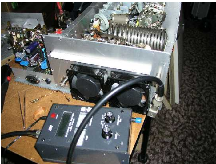
Obr. 27: Přednastavení Pí-článku pomocí SWR ANALYZERU MFJ-259B
