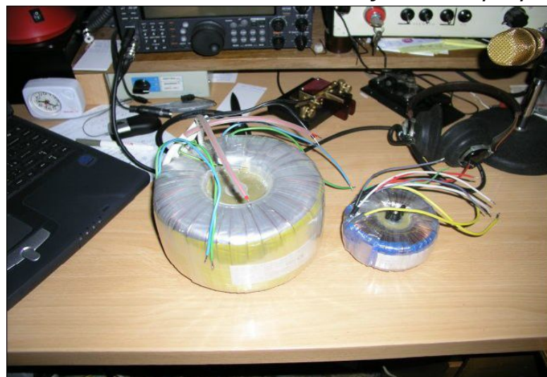
Ilustrace 4: Trafo v levo je pro vysoké napětí, v pravo pomocné trafo.
